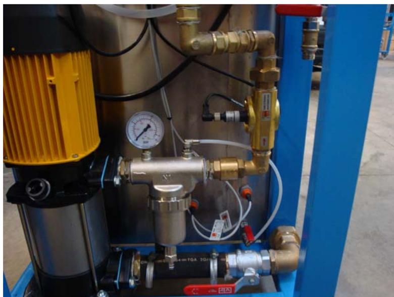
El equipo puede disponer de hasta 3 salidas separadas para la mezcla, cada una con su válvula de corte manual. Además se ha incorporado una cuarta salida para coger muestras de producto en caso necesario:
