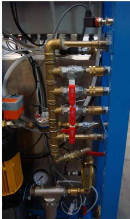
Esta nueva versión monta variador de velocidad para la bomba de impulsión de producto al lubricador. De esta manera se controla la presión de un modo constante.
