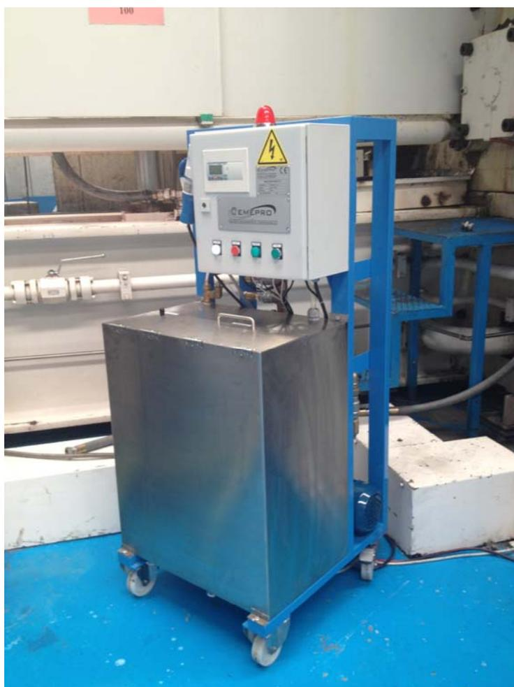
El equipo esta diseñado para crear la mezcla de producto desmoldeante puro y agua según el porcentaje establecido por el usuario.
